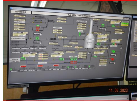
ภาพที่ 2.2-2 ระบบ DCS ของหน่วยกำจัด 1,3-Butadiene
