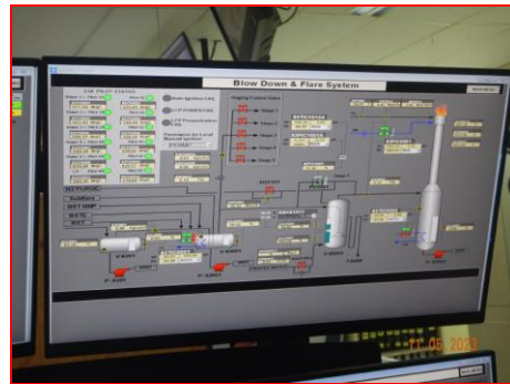
ภาพที่ 2.2-7 ระบบ DCS ของหอเผาทั้ง ระดับเหนือพื้นดิน (Elevated Flare)
