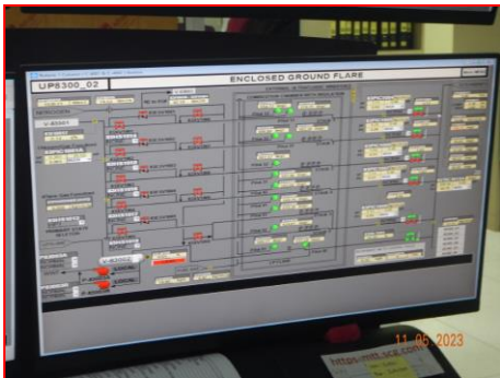
ภาพที่ 2.2-8 ระบบ DCS ของหอเผาทั้งระดับพื้นดิน แบบมิดชิด (Enclosed Ground Flare Pilot)
